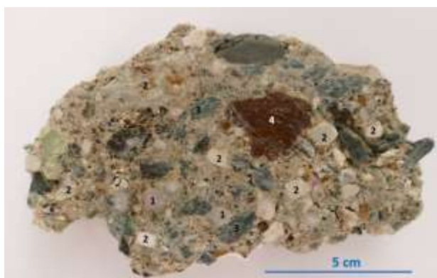
Fig. 35 Conglomérat dans CL1. Les clastes sont des calcaires gris (1), des quartzites blancs (2), des schistes chloriteux frais (3) et altérés (4). La calcite translucide constitue le ciment. Les pores résiduels sont bordés d'une couronne de microcristaux de calcite indiquant une cimentation vadose (Scholle lit. cit.). Cette dernière a nécessité une exposition atmosphérique prolongée et des eaux de surface courantes.
