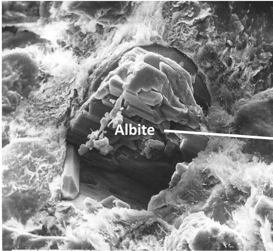
Grès Permien, Mer du Nord. Grain arrondi d'abord dissout, puis remplacé par de l'albite. L'albite est un feldspath de Sodium.
